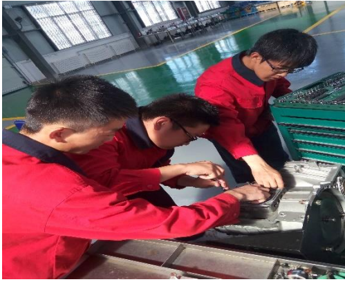
学生团结协作 紧张地进行变速器拆装操作
